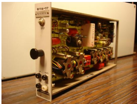
Figur 1: Exempel på TM-10 kortkassett. Ett FSK-modem DT106.
