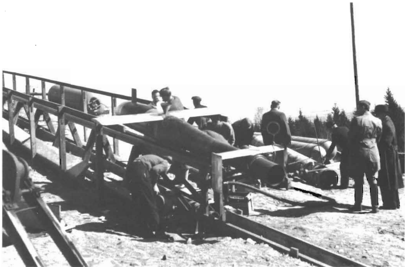
En av våra första försöksrobotar – Rb 310 – vid prov på försöksskjutplatsen vid RFK i Karlsborg (numera FFK). I stort en "V 1"-motor med vingplan påmonterade.
