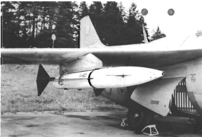
Prototypen till robot 04 under flygprov på flygplan 29 vid Försökscentralen.
