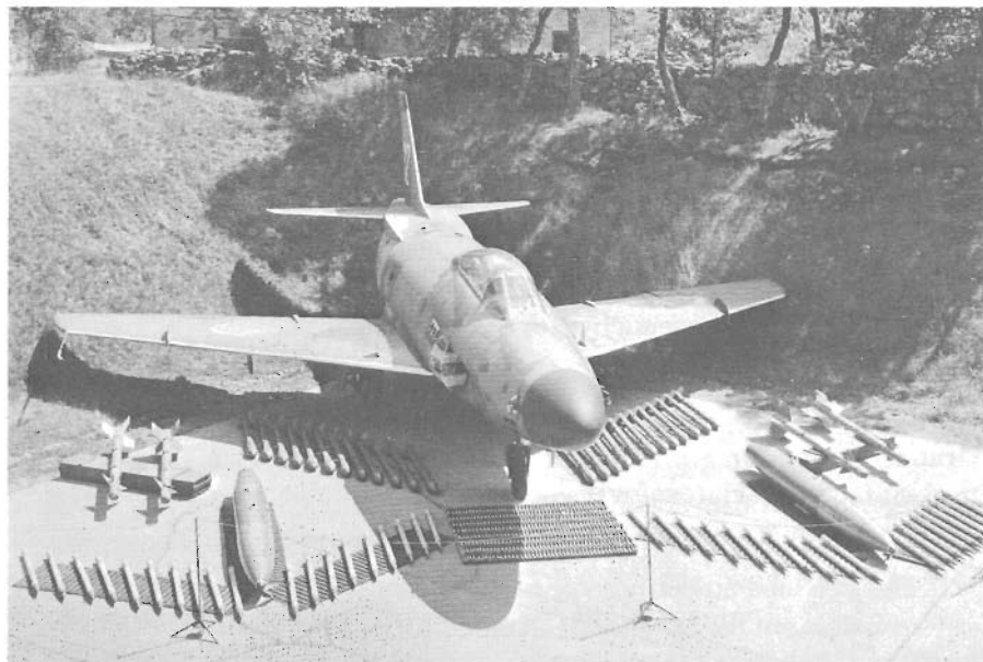
Beväpningen i flygplanet. Närmast de två raketkapslarna med 38 jaktraketer urtagna. I mitten automatkanonammunitionen. Närmast flygplanet fyra sidewinderrobotar och 24 attackraketer.
