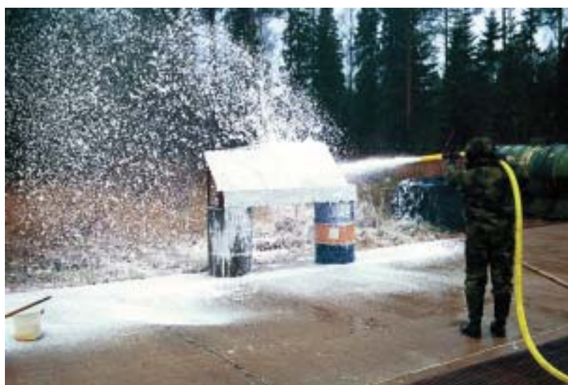
Amröjskyddssats/S kan också användas utan tältet, då för ren ytsanering av B- och C-stridsmedel. Skummets klibbiga konsistens gör att det lätt fastnar på väggar eller materiel som behöver saneras. Vid ytsanering tillsätts skummet extra saneringsmedel.
