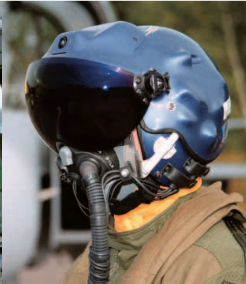
Guardianhjälm erbjuder avancerad teknologi och god precision, men väger hela 1,8 kilo. I kombination med höga G-krafter har det visat sig ge en rejäl påfrestning på pilotens nacke. Guardian provflögs senast i Gripen sommaren 2002.
