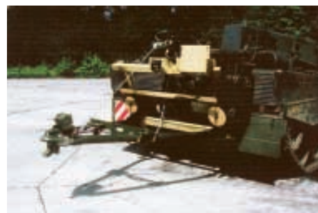
Bgbv 120 har ett unikt kopplingsystem som gör att personalen kan koppla till ett skadat fordon utan att de behöver lämna sitt pansarskydd. Här sitter en prototyp av kopplingen på ett försöksfordon under testerna av systemet. Foto: Rheinmetall Landsysteme GmbH.
